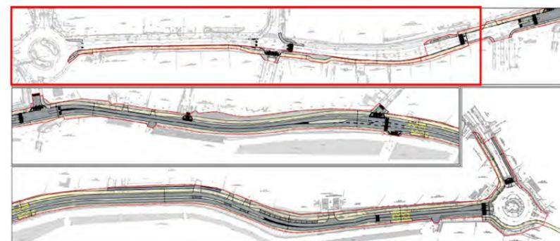
Le chantier de création de cette nouvelle piste dédiée aux déplacements non motorisés s'accompagnera d'importants travaux de réaménagement de voirie : réalisation de trottoirs, redimensionnement des voies de circulation, reprofilage des talus, intégration d'un plateau surélevé et d'un terre-plein central...
